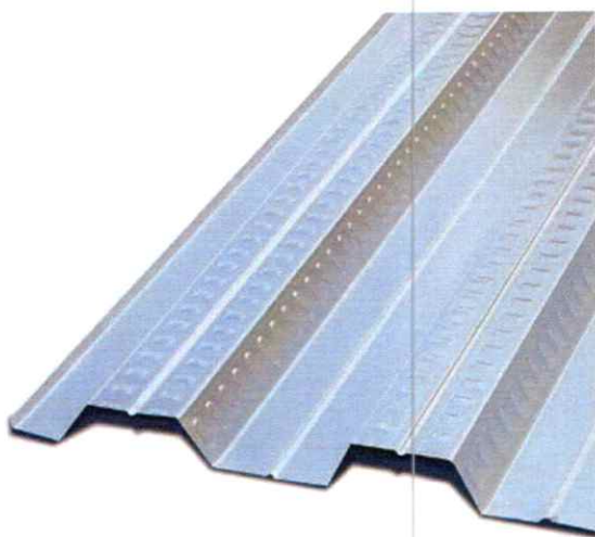
IMAGEN REFERENCIAL: Placa colaborante galvanizada de 0,8 x 950 mm x 6 m / Malla electro soldada C-92 de acero AT56-50H.
